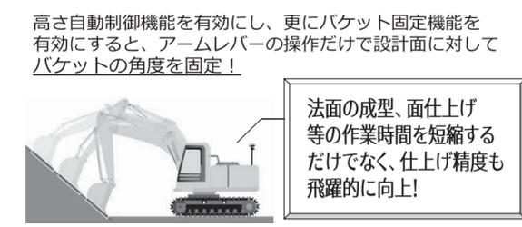
高さ自動制御機能を有効にし、更にバケット固定機能を有効にすると、アームレバーの操作だけで設計面に対してバケットの角度を固定!
