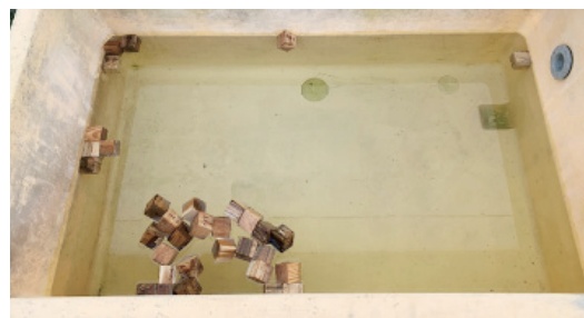
写真-4 流木の水浸漬実験の様子
