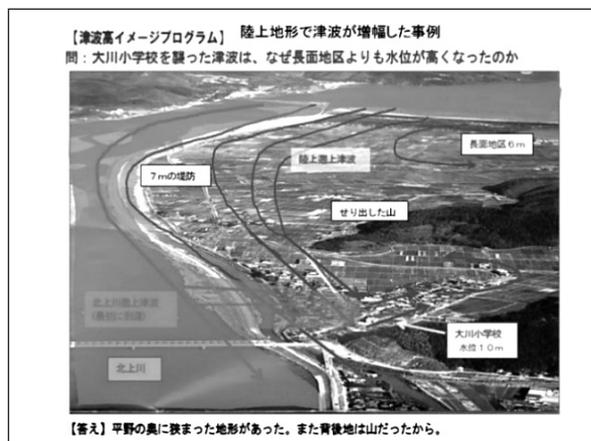
図2 陸上地形で津波が増幅した事例
