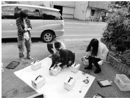
写真-1 微動アレー探査
