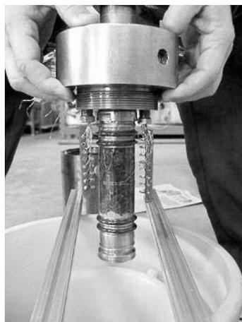
写真-2 セル圧媒体(油)が供試体被覆材の隙間より岩石供試体内部へ浸透した様子
