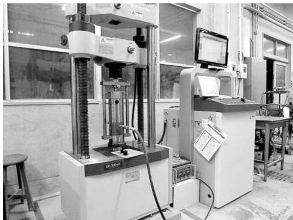
写真-1 Breadthauer 型三軸ベッセルと材料試験機
