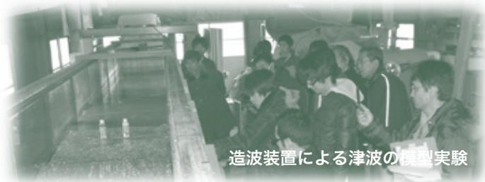
造波装置による津波の模型実験
